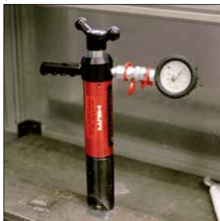
Prueba de tensión de una fijación X-ENP con un extractor HAT 28 y un acople ENP.
