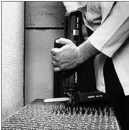
Prueba de vida útil de la herramienta a pólvora DX con barrilete de clavos.
