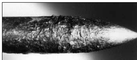
Punta limpiada mecánicamente de un fijador DX desprendido
